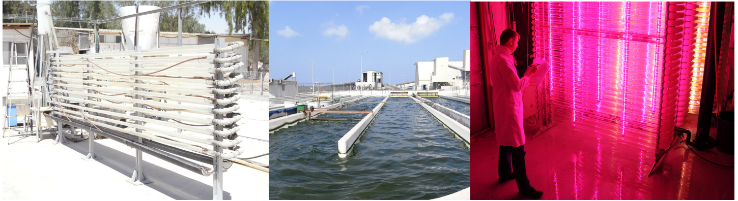
Figur 2: Dyrkning af mikroalger med forskellige teknikker. Yderst til højre og venstre to forskellige fotobioreaktorer, i midten en raceway pond.
